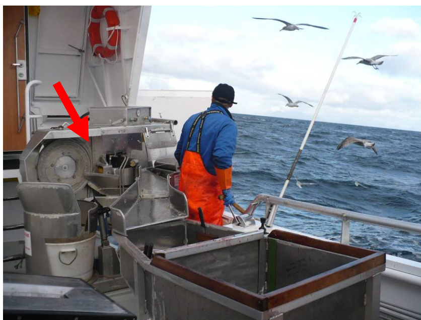
Bilde 11 Linehaler er plassert framme på åpent arbeidsdekk på styrbord side
