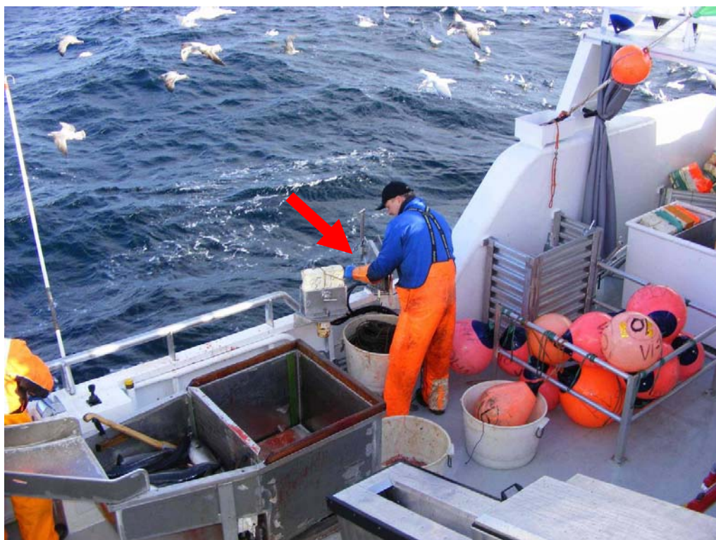
Bilde 15 Kveileapparat på styrbord side for haling av iler og fløyt
